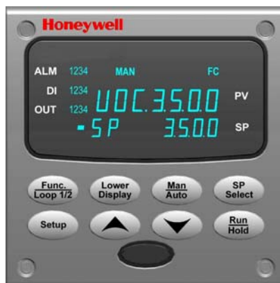
Рис. 2 – Лицевая панель контроллера UDC3500
