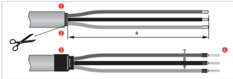
Рис. 4-9. Подготовка кабеля тока возбуждения С для преобразователя сигналов
