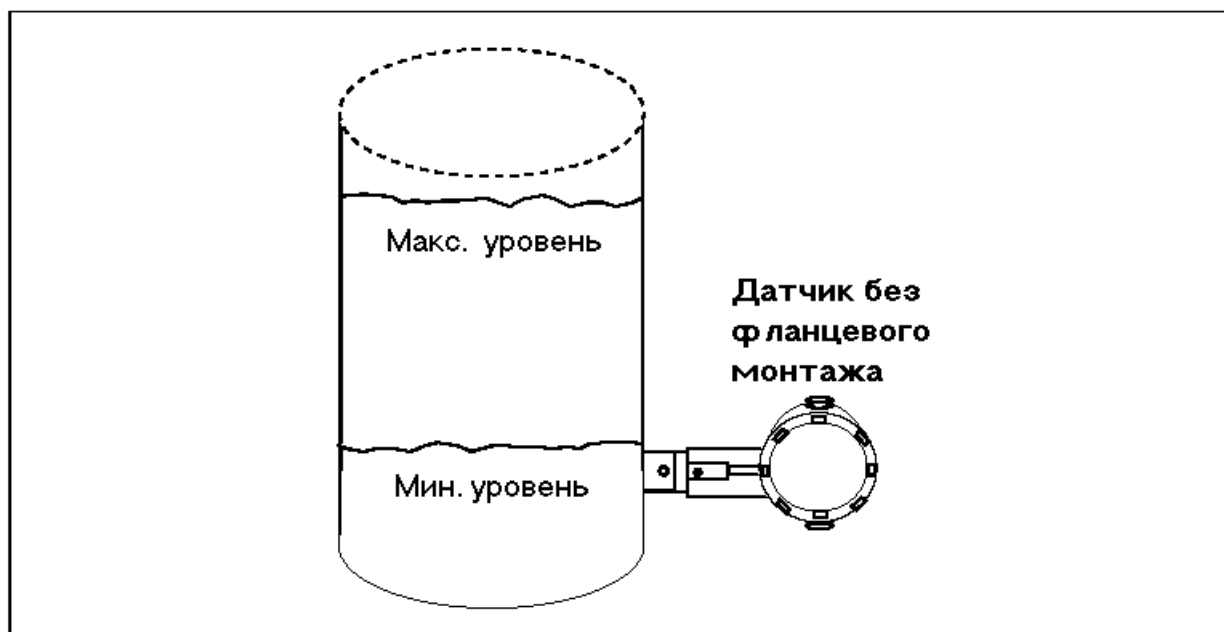
Рис. 46 Типовая схема обвязки датчика без фланцевого монтажа для измерения уровня жидкости
