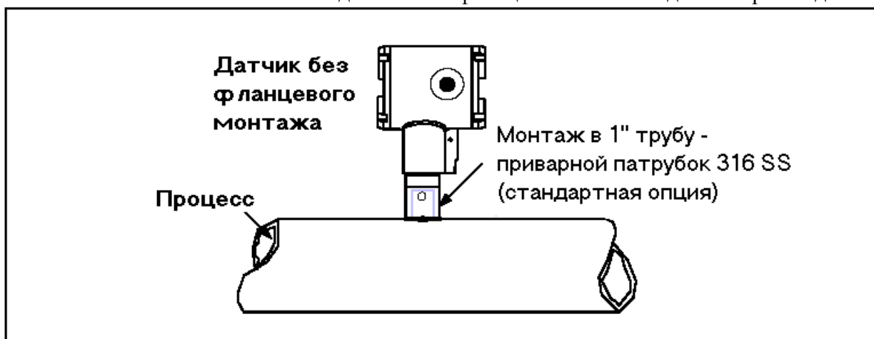
Рис. 45 Типовая схема обвязки датчика без фланцевого монтажа для измерения давления
