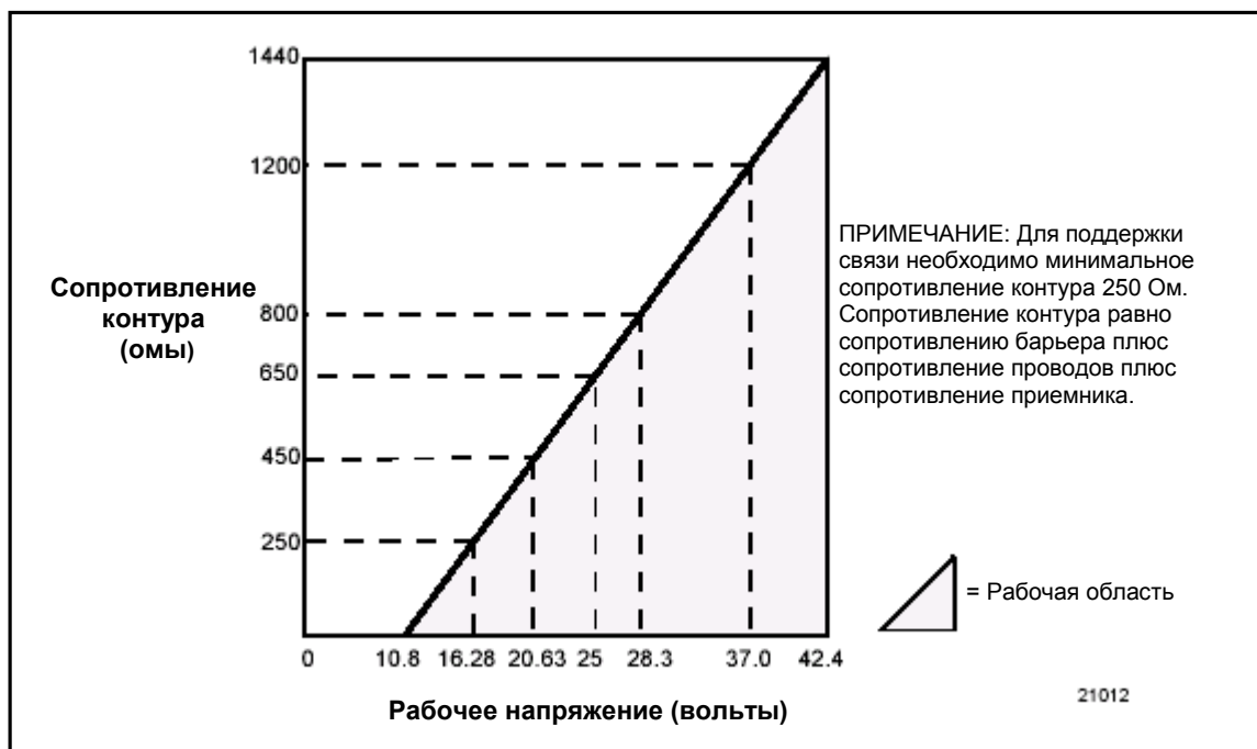
Рис. 2—График зависимости сопротивления контура от напряжения питания
